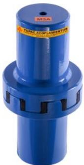
Como puede apreciarse en la foto los acoples especiales son de dimensiones distintas a los convencionales, aunque el cálculo de la potencia transmitida (RPM y HP) es el mismo que los de la línea M y se hacen a pedido de los clientes. Tienen las mazas mas largas que lo normal y sirven para unir ejes donde el espacio a acoplar es más amplio y no se puede utilizar los acoplamientos convencionales. Se los denomina acoplamiento elástico Tupac M Largo.
